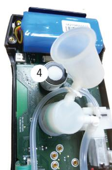
Nuevo sensor conectado a la tarjeta electrónica
