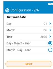
Ajuste la fecha pulsando OK en cada línea, utilice las teclas Arriba y Abajo para seleccionar el elemento correcto, valide con OK y a continuación vaya a **"Siguiente"**.
