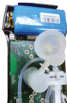
Nuevo sensor conectado a la tarjeta electrónica
