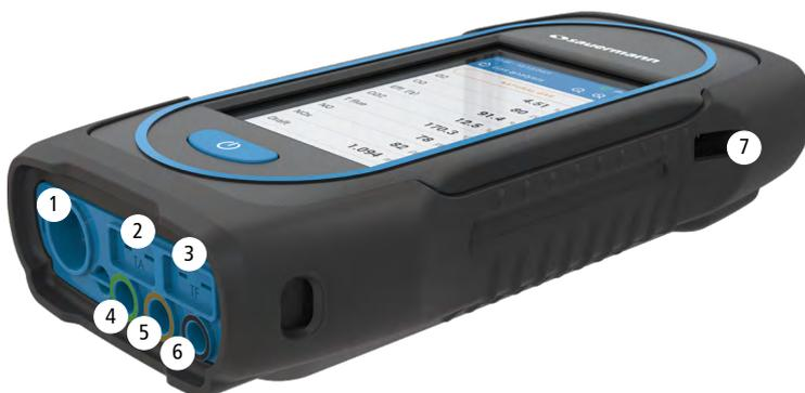
1. Conexión Mini-DIN para sondas opcionales de CO y CO<sub>2</sub>
