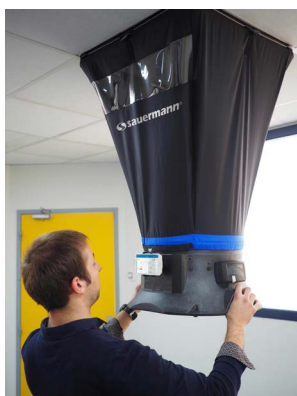
Colocación del caudalímetro
