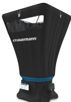
Las campanas son estancas y disponen de una franja transparente frente al usuario que permite ver a través de la salida de aire y comprobar así que la campana está bien instalada. Las varillas, de fibra de carbono, garantizan la correcta rigidez de las campanas.
