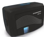
**El módulo electrónico del caudalímetro, extraíble, cumple perfectamente la función de micromanómetro.** Útil complemento para la medición aerúlica, este instrumento permite, conectando un tubo de Pitot, medir la velocidad del flujo en el conducto o, conectando dos tubos de silicona, comprobar la obturación de los filtros de una central de aire.
