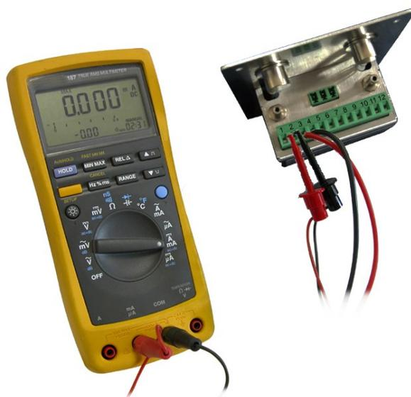
Conexión de las salidas de corriente 0/4-20 mA:
